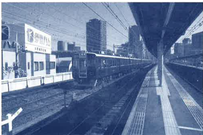
中津駅。京都線の普通列車が通過していきます。ホームの点字タイルに注目。安全スペースがほとんどありません。
